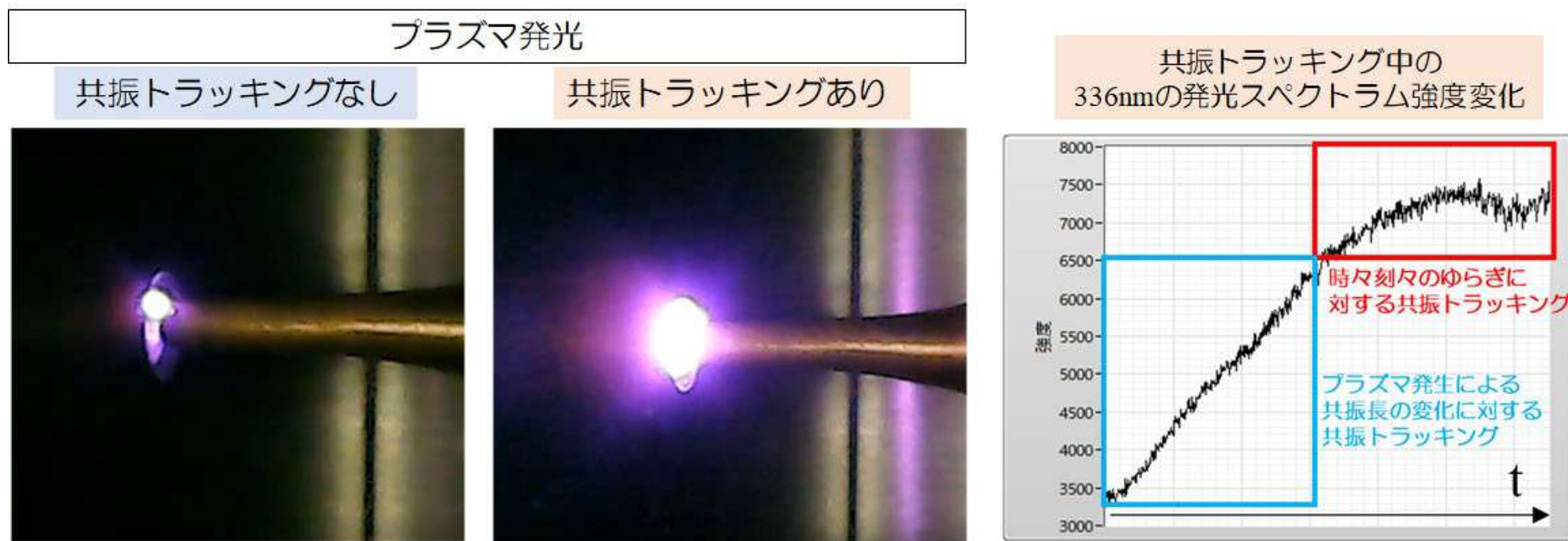
図2：共振トラッキングの有無によるプラズマ発光強度の変化
