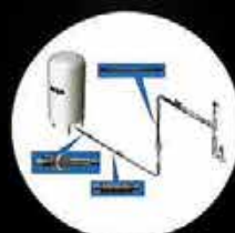
CEタンク・ 真空断熱配管
